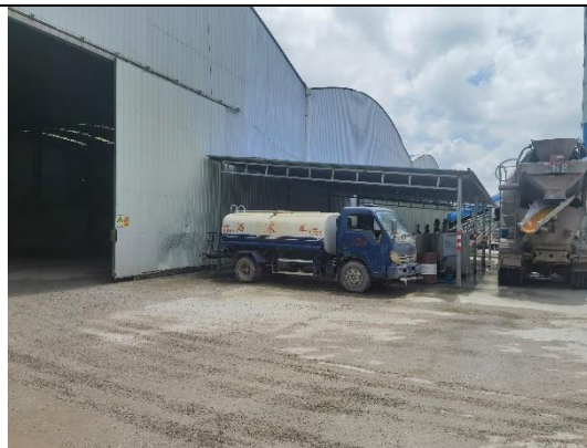
封闭料仓及洒水车
